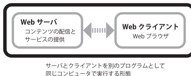
図 130: 同一のコンピュータ内でサーバとクライアントが連携するケース
